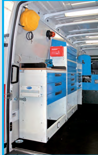
Iveco Daily con estanterías y cajones, con generador de 15 Kwa y compresor 100 litros.
