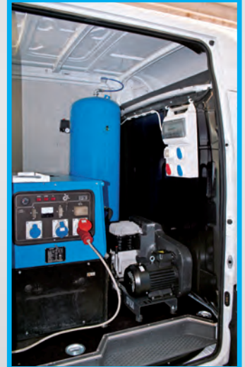
Iveco Daily con estanterías y cajones, con generador de 15 Kwa y compresor 100 litros.
